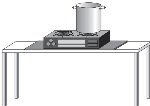
机の上に断熱材・ボードを置いて、その上で熱器具を使用してください。
